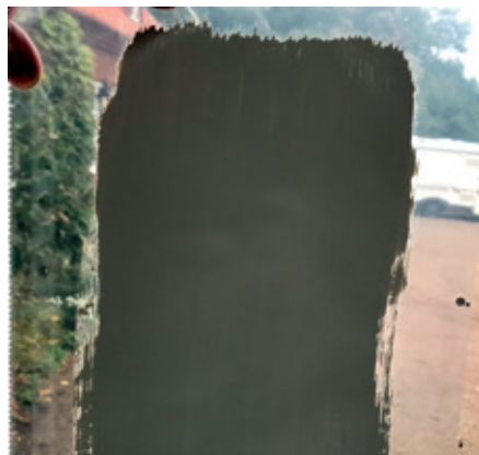
Maalaa muovikalvolle vastavalossa. Yhden maalauskeran tulisi olla täysin peittävä. Noin 100 my.
